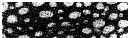
Рис. 114. Капли росы полярного вещества в поле зрения поляризационного микроскопа.
