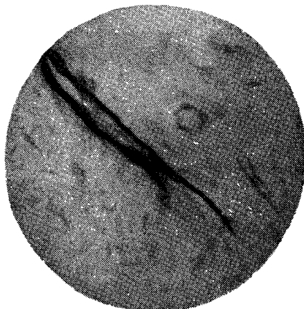
Рис. 25. Субмикроскопическая трещина на поверхности стали 30-ХГСА. Напряжение 16 \text{ кг/мм}^2 , увеличение \times 15\,000 .
