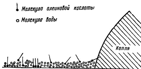
Рис. 205. Схема растекания капли полярной жидкости по поверхности стекла, несущей адсорбционный слой воды.
