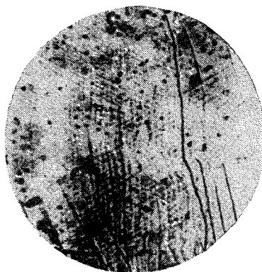
Рис. 27. Плоскость раскола кристалла Bi, образованного из расплава.
