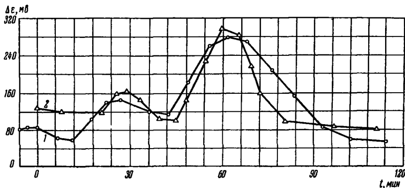
Рис. 203. Та же зависимость, что и приведенная на рис. 202. Мультимолекулярный граничный слой. Периодический ход кривой. Кривые 1 и 2 — результаты двух экспериментов, осуществленных в одинаковых условиях.
